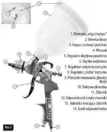
Схема работы краскопульты с верхним баком
